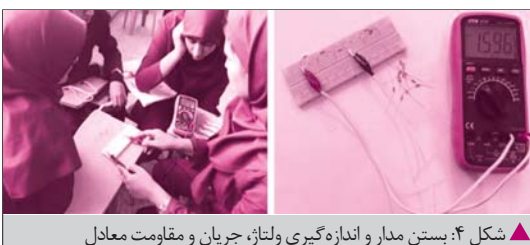
▲ شکل ۴: بستن مدار و اندازه‌گیری ولتاژ، جریان و مقاومت معادل
